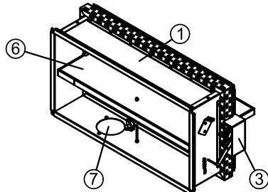
• Задействащият елемент - специално вградената стопялена пластина (8) реагира, ако температурата на въздуха преминава през отвора на клапата надвиши 65°C. При надвишаване на тази температура припоя се стопява, затварящия пружинен механизъм (3) се задейства и затваря подвижният огнеупорен панел (2). Ревизионния отвор (7) служи за извършване на преглед на състоянието на задействащия елемент (8) и при нужда за подмяната му.
