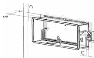
4. Проверка на диагоналите и нивелиране на клапата
